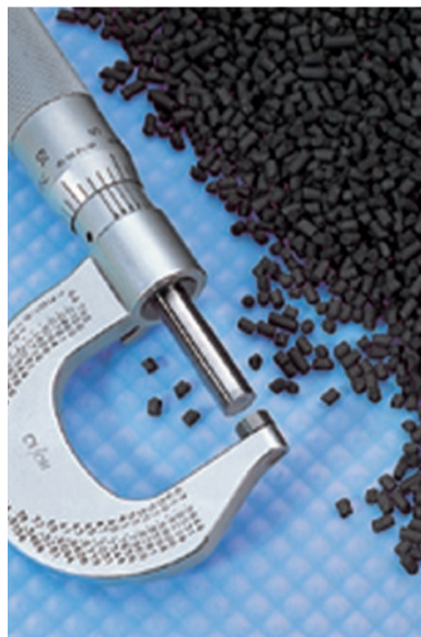
Partikel aus dem Kohlenstoff-Molekularsieb.
